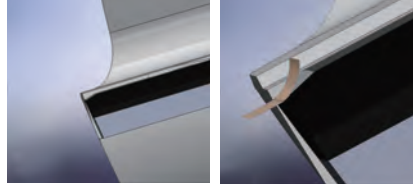
Edge honing specification cutting edge
